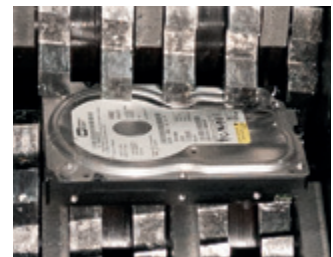
Die Schneidwellen aus gehärtetem Vollstahl sind unempfindlich und garantieren Langlebigkeit.
