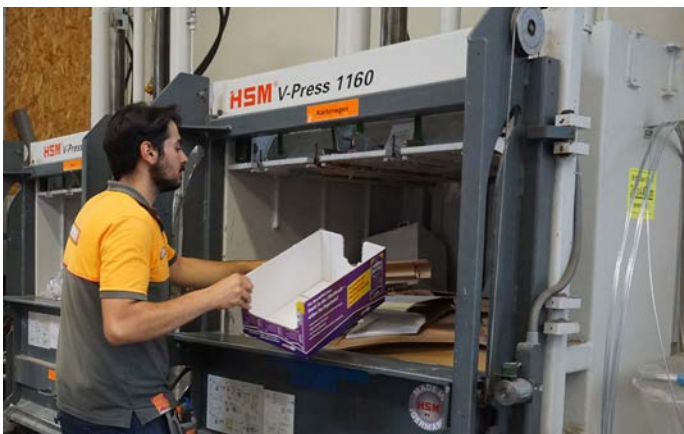
Riempimento di una pressa HSM V-Press 1160 con cartone
