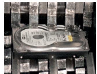
Los rodillos, de sólido corte de acero endurecidos por inducción son robustos y garantizan un alto nivel de durabilidad.
